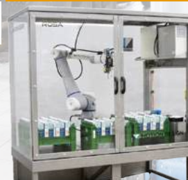
Robot de préparation d'échantillons sur briques de lait
